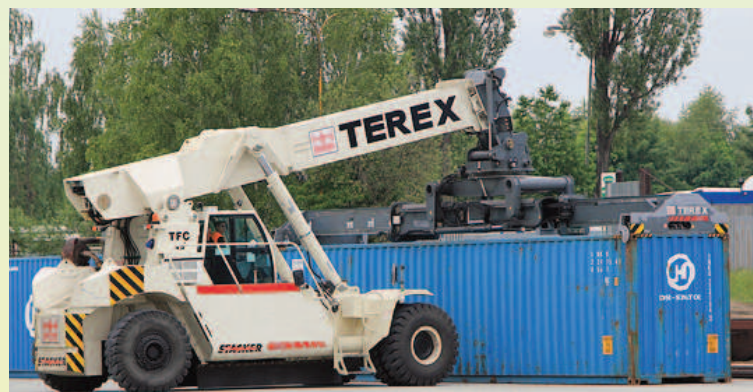
Vier dieser Reachstacker sowie ein Portalkran sind auf dem neuen Inland-Terminal der HHLA Tochter METRANS im tschechischen Ostrava im Einsatz.
